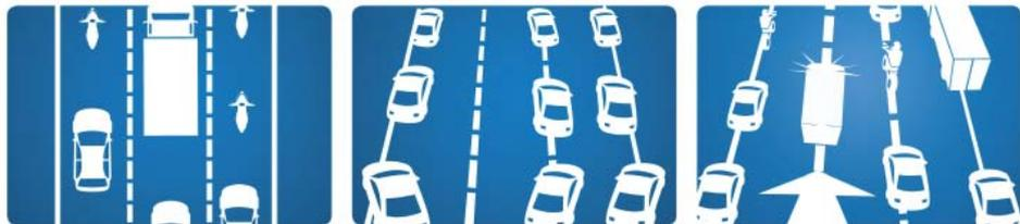
Die Rettungsgasse funktioniert nur dann, wenn sich alle VerkehrsteilnehmerInnen daran halten, und den Einsatzkräften eine schnelle und sichere Zufahrt zum Unfallort ermöglichen. Die Behinderung von Einsatzfahrzeugen sowie widerrechtliches Befahren der Rettungsgasse ist verboten und wird mit bis zu 2.180,- Euro bestraft. Die Rettungsgasse kann auch Ihr Leben retten! Weitere Informationen unter [www.rettungsgasse.com](http://www.rettungsgasse.com)
