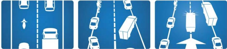
Bei drei- oder vierspurigen Straßenabschnitten muss die Gasse zwischen dem äußerst linken und dem daneben liegenden Fahrstreifen gebildet werden. Alle Fahrzeuge auf der äußeren linken Fahrspur fahren nach links, alle anderen Fahrzeuge nach rechts.
